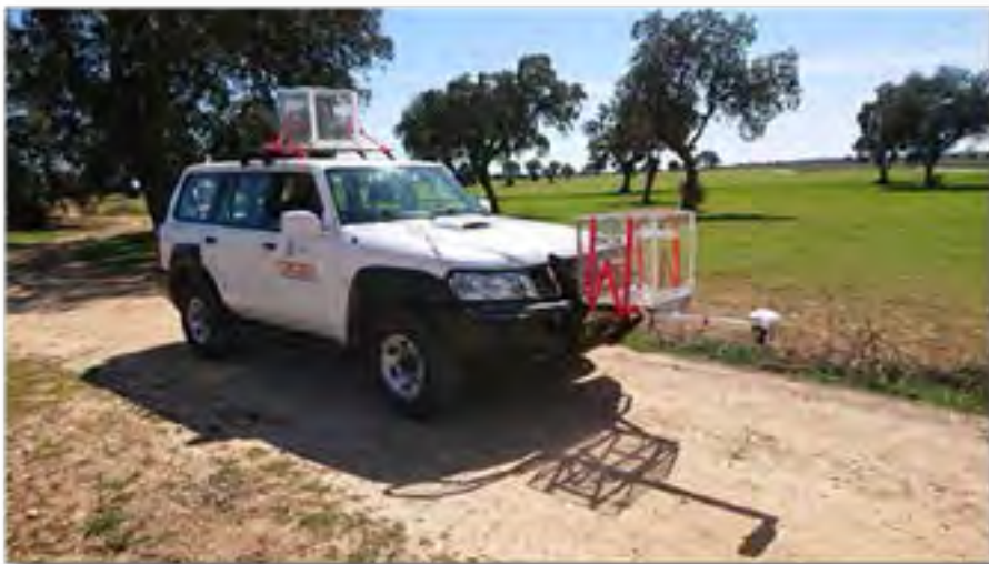
Instalación de dos colectores a diferente altura para los ensayos 2 y 3. En el extremo anterior se ha instalado una cámara web para la grabación de los ensayos
