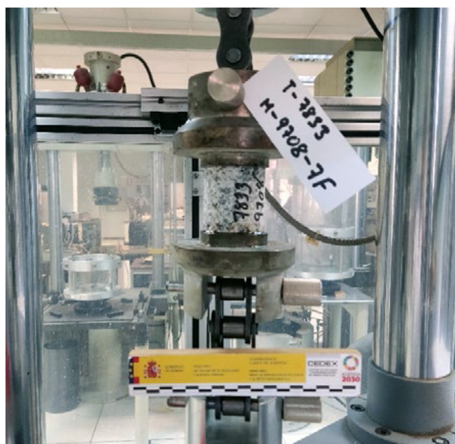
Ensayo de tracción directa sobre una muestra granítica de baja esbeltez
