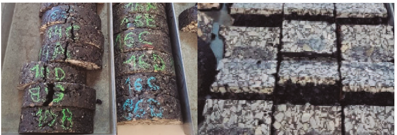
Probetas de mezcla bituminosa fabricadas con RA
