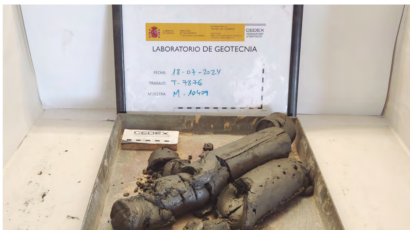
Material extraído de uno de los tubos Shelby recibidos en el Laboratorio de Geotecnia para la realización de ensayos
